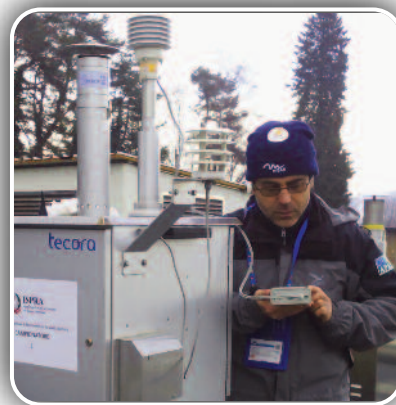
Campionatore del particolato atmosferico. Fonte: ISPRA
