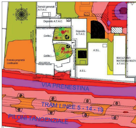
Mappa del livello sonoro a 3 m di altezza LAeq [dB(A)] durante il periodo di riferimento diurno
