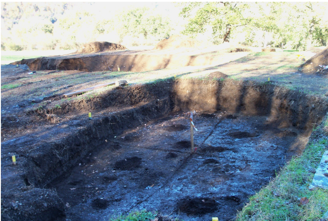
Figure 3 – Tracciamento sul fondo dello scavo M9 ( A = 29 \text{ m}^2 ) per la composizione del campione C-M9-A con 4 aliquote dal fondo e 4 da parete; vertici topografici segnalati da picchetti gialli
